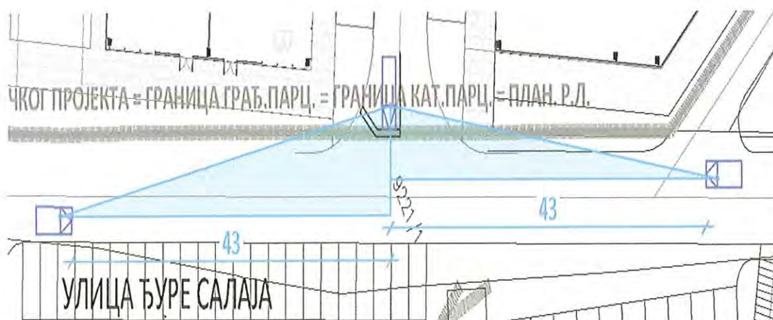
Слика 3.3 Троугао прегледности на улазу/излазу у улици Ђуре Салаја
